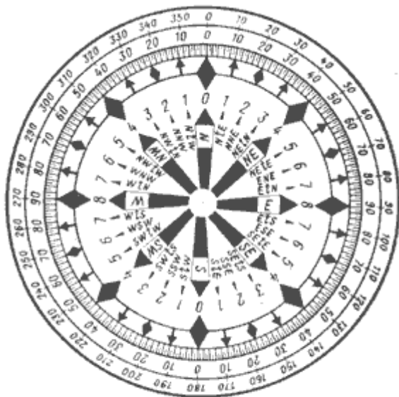
Рис. 7. Системы деления горизонта: внутренний круг — румбовая; средний — четвертная; наружный — круговая
