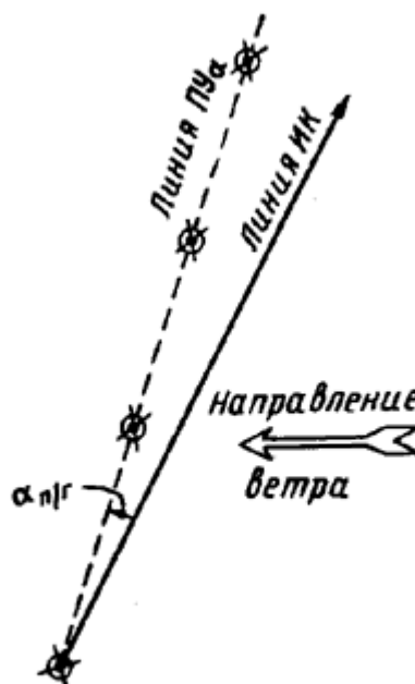
Рис. 34. Определение угла дрейфа
